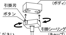
4 フランジを取り付けてください。フランジは引掛けシーリングがかくれるように押し上げ天井に密着させてください。
