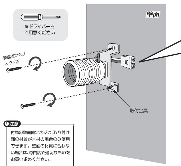
配線の接続方法 端子ボックスの端子穴に引き込み線を差し込みます。
