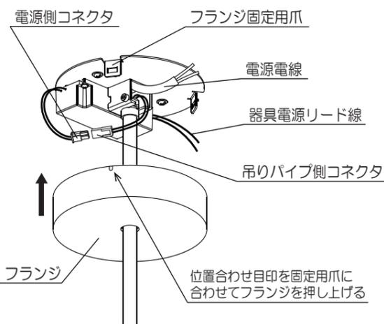
3. 電源電線の結線およびコネクタの接続 (結線部詳細図参照)
