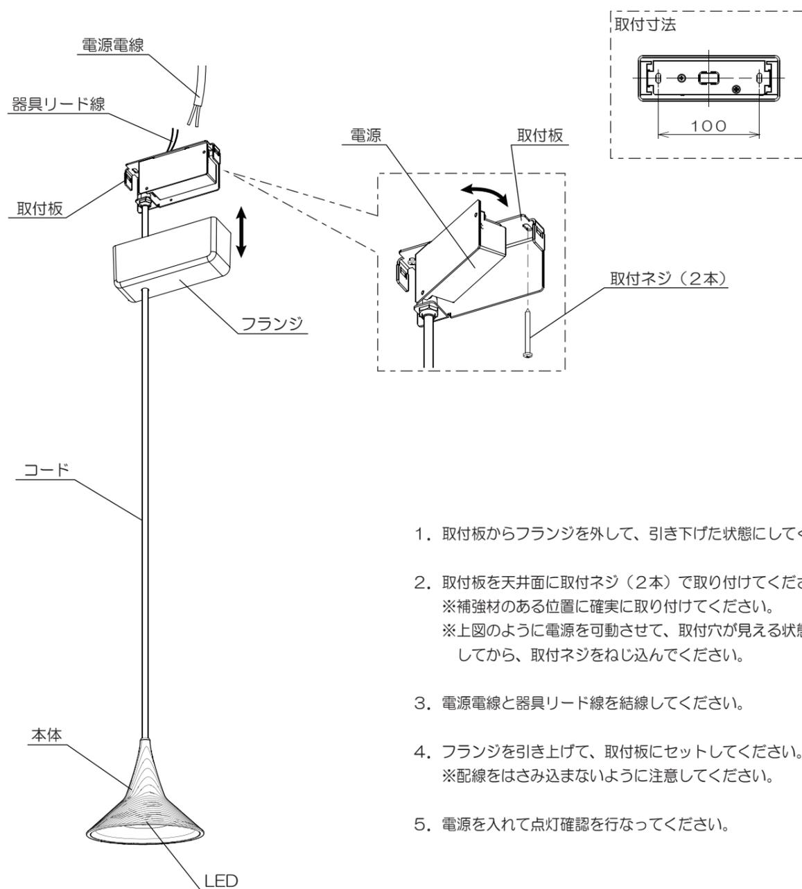
1. 取付板からフランジを外して、引き下げた状態にしてください。
