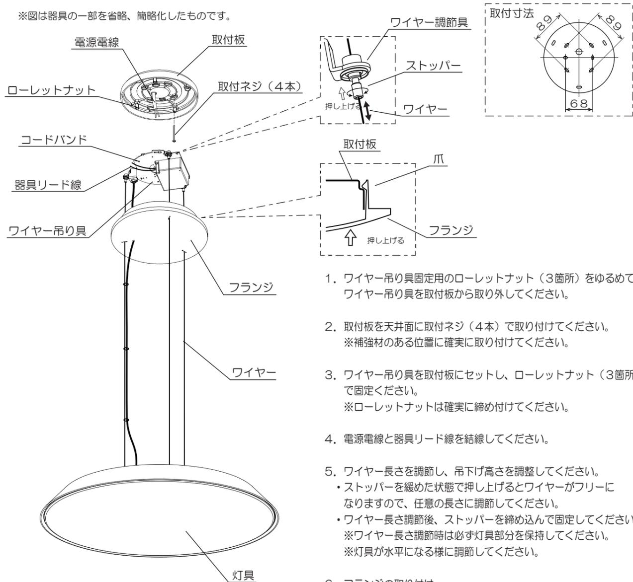
1. ワイヤー吊り具固定用のローレットナット（3箇所）をゆるめてワイヤー吊り具を取付板から取り外してください。
