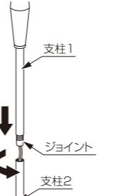
コードが捩じれていくと断線の恐れがあるため、必ず下に取り付ける支柱を回してください。
