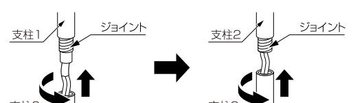
○ コードの余計な捩じれを防ぐため、必ず下に取り付ける支柱を回してください。
