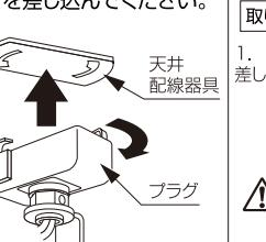
△ 取り付け及び取り外しの際に、無理な角度で回したり、強い力で扱うとプラグが破損します。
