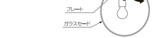
3.セードカバーを下ろし、図のようにプレートとはさむようにセード固定ネジで固定してください。
