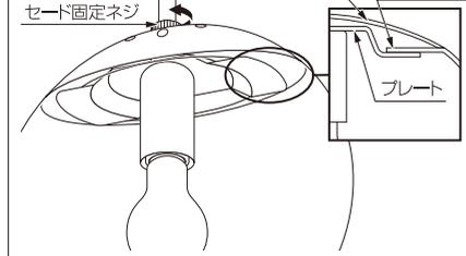
**警告** ネジを固定する前に、プレートにガラスセードが乗っているか、ガラスセードがプレートと平行になっているかを確認してください。ネジを固定した後は再度、ガラスセードがしっかりと固定されているかを確認してください。
