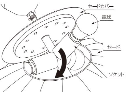
○ 電球や支柱の先端がセードに当たって破損する恐れがあるので、必ずソケットを傾けて、1つずつ慎重に入れてください。
