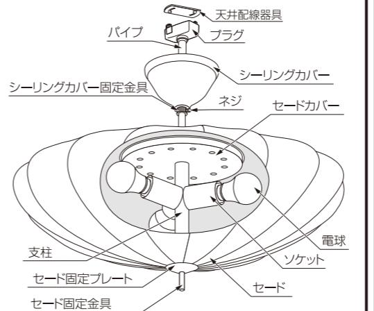
2.セード下の穴から支柱先端のセード固定ネジを出し、セード固定プレートを通してしっかりと取り付けます。
