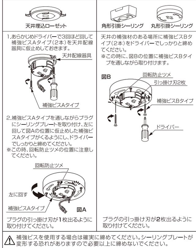
⚠補強ビスを使用する場合は確実に締めてください。シーリングプレートが変形する恐れがありますので必要以上に締めないでください。
