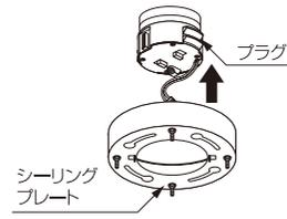
⚠天井配線器具によって取り付け完了時のシーリングプレートの位置が違います。
