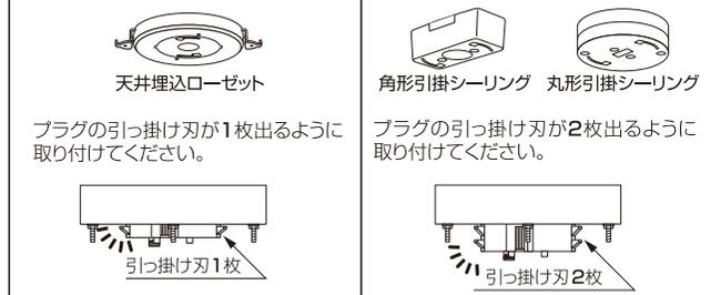
この時、回転防止ツメにプラグの引っ掛け刃が接触しないようにしてください。落下の原因となります。
