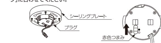
**警告** プラグの引っ掛け刃が回転防止ツメに接触している場合は赤色つまみが動きません。必ずプラグの引っ掛け刃が完全に出た状態で赤色つまみを「●レバーロック」に合わせてください。
