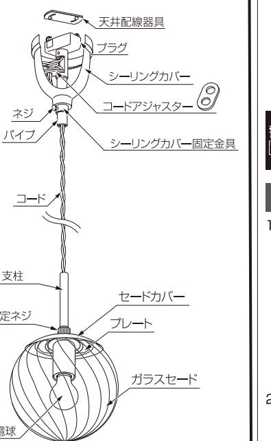
③セードカバーを下ろし、図のようにプレートとはさむようにセード固定ネジで固定してください。
