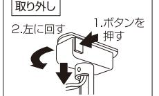
**危険** WAR. 取り付け及び取り外しの際に、無理な角度で回したり、強い力で扱うとプラグが破損します。
