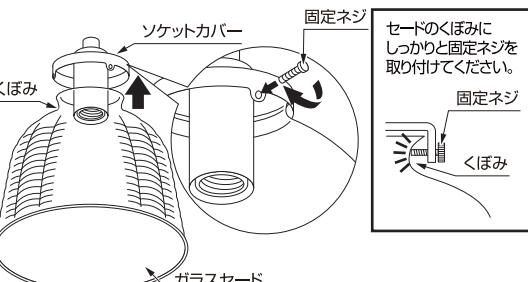
△ ネジを固定した後に再度、ガラスセードがしっかりと固定されているか確認してください。
