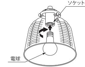
φ37mm 電球をお取り替えの際、下部が閉じている形狀のセードは、口径をご確認いただき、交換をしてください。
