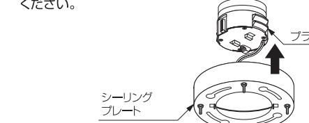
**⚠ 天井配線器具によって取り付け完了時のシーリングプレートの位置が違います。**
