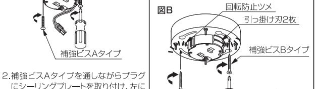
2.補強ビスAタイプを通しながらプラグにシーリングプレートを取り付け、左に回して図Aの位置に仮止めした補強ビスAタイプがくるようにして、ドライバーでしっかりと締めてください。
