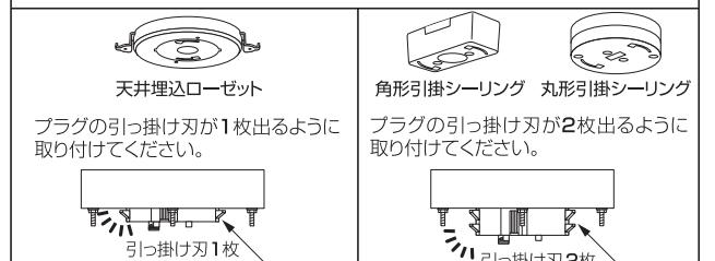
**⚠** この時、回転防止ツメにプラグの引っ掛け刃が接触しないようにしてください。
