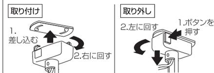
取り付け及び取り外しの際に、無理な角度で回したり、強い力で扱ったりするとプラグが破損します。十分注意してお取り扱いください。
