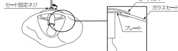
**警告 WAR.** ネジを固定する前に、プレートにガラスセードが乗っているか、ガラスセードがプレートと平行になっているか確認してください。ネジを固定した後は再度、ガラスセードがしっかりと固定されているか確認してください。
