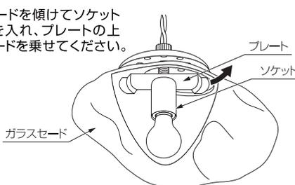
③セードカバーを下ろし、図のようにプレートとはさむようにセード固定ネジで固定してください。
