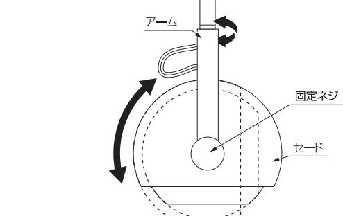
・角度調整後は固定ネジを締め、しっかりと固定してください。
