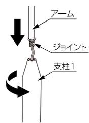
支柱1を手を持ち、ジョイントを穴に合わせ、支柱2を左に回して固定してください。
