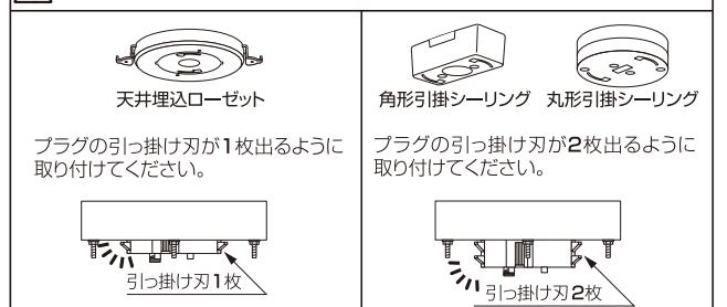
この時、回転防止ツメにプラグの引っ掛け刃が接触しないようにしてください。落下の原因になります。
