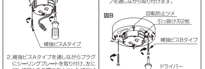
2.補強ビスAタイプを通しながらプラグにシーリングプレートを取り付け、左に回して図Aの位置に仮止めした補強ビスAタイプがくるようにし、ドライバーでしっかりと締めてください。
