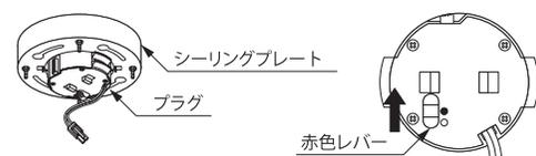
**警告 WAR.** プラグの引っ掛け刃が回転防止ツメに接触している場合は赤色のレバーが動きません。必ずプラグの引っ掛け刃が完全に出た状態で赤色レバーを「●レバーロック」に合せてください。
