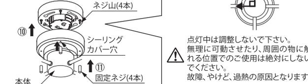
この時にネジ山をシーリングカバー穴に通す位置で角度を調整します。
